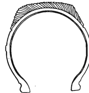
Рис. 38. Пример профиля протектора, полученного методом навивки узкой ленты резиновой смеси
