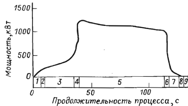
Рис. 19. Диаграмма потребления мощности по операциям и времени для 2-й стадии изготовления протекторной смеси в резиносмесителе вместимостью 620 дм 3
