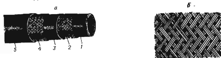
Рис. 91. Напорный рукав с каркасом оплеточной конструкции: а — общий вид; б — структура оплетки; 1 — внутренняя камера; 2, 4 — прокладки каркаса; 3 — промежуточный резиновый слой; 5 — резиновая обкладка
